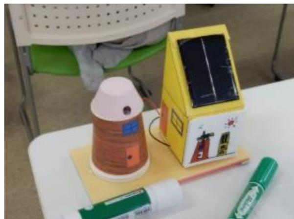
スチロールの台の下に出した、ソーラーパネルと風車用モーターのリード線をはんだ付けでつなぎ、絶縁テープで固定しました。リード線のはんだ付けは指導員が行いました
